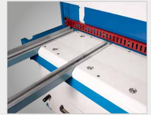
Arbeitstisch mit Auflagearmen und Transferkugeln
