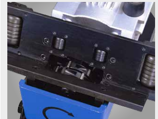
▶ mit zwei 6-fach Wendepplattenhalter
