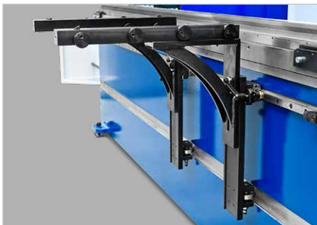
► Blechauflagearme auf Linearachse verfahrbar
