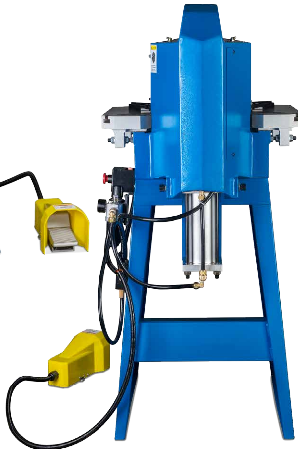
▶ Anschläge mit Gehrungsverstellung
