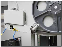
angetriebene Späneräubbürste zur Reinigung und Instandhaltung des Sägebandes
