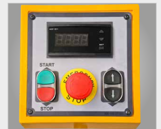
► Digitale Positionsanzeige für Zustellwalze
