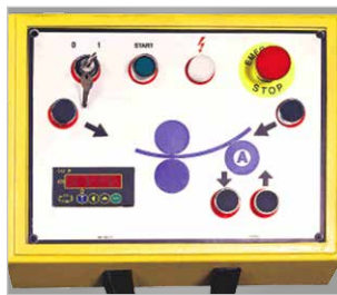
▶ Bedienpanel mit Digitalanzeige und manueller Bedienung (Option)
