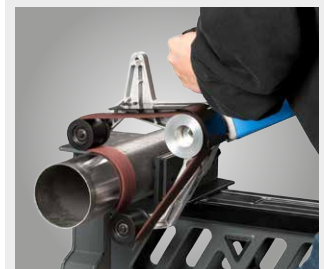
Nur zwei Arbeitsschritte notwendig für 360° Umfangschleifen
