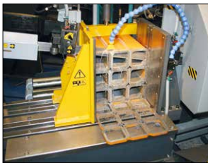
▶ Abb. mit optionaler Bündelspannvorrichtung (Art.-Nr. 3640130) und mit optionalem Schraubstock hinter dem Schnitt (Art.-Nr. 3640132)
