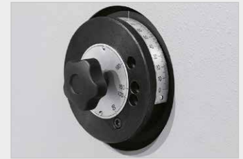
► serienmäßige Steuerung MA - manuelle Verstellung des Biegewinkels mittels Skalenring an der linken Maschinenseite
