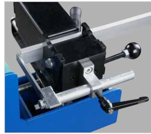
► Werkzeuglos verstellbarer Längenanschlag (nur bei 90°)
