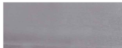
Anwendung Edelstahl schleifen eingesetztes Schleifband K 120 zur Oberflächenstrukturierung
