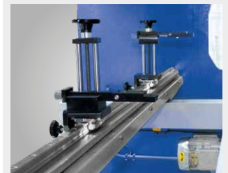
▶ Hinteranschlagfinger auf Linearführung seitlich und über Spindeln in der Höhe verstellbar
