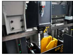
▶ 2 Säulen Linearführung mit hydr. Zylinder
