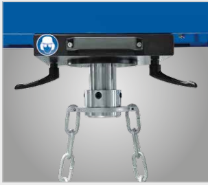
► Kette für Tischhöhenverstellung über stabilen Flansch am Zylinder befestigt
