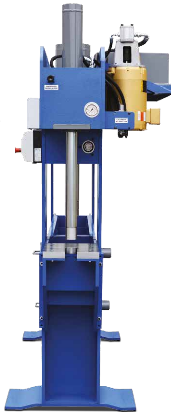
▶ Druckempfindliche Handhebel und Druckmanometer
