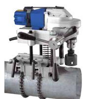
RB 127 Halterung für Rohre 32 - 203 mm
