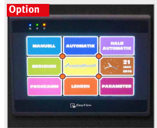
► Option: NC-Steuerung mit Touchscreen und Teach-In-Funktion
