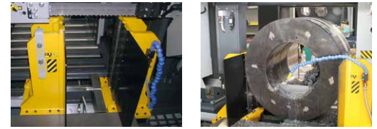
► Klemmung des Materials vor und hinter dem Schnitt durch zweigeteilten Schraubstock
