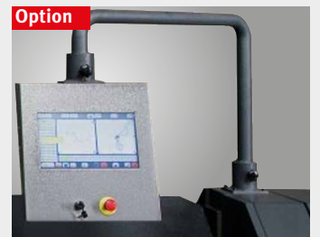
► Optionale CNC-Steuerung mit 3D-Graphik , die Profile werden vom Bediener auf einem großzügigem 19" Touchscreen gezeichnet, sämtliche Achspositionen und die Biegefolge werden von der Steuerung errechnet, motorischer Hinteranschlag mit Anschlagfingern, Verfahrbereich 15-1000 mm
