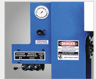
▶ Druckempfindliche Handhebel und Druckmanometer
