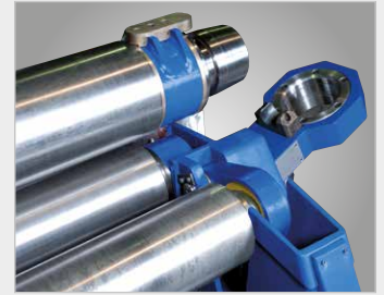
Hydraulisches Klapplager zur leichten Entnahme des Materials
