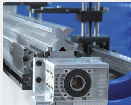
▶ CNC-gesteuerte, motorische Tischbombierung (Standard bei S- und Servo-Reihe)
