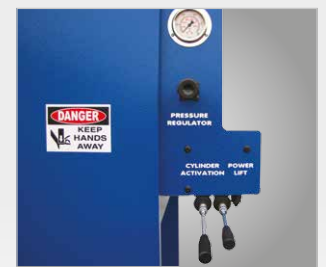
▶ Druckempfindliche Handhebel und Druckmanometer
