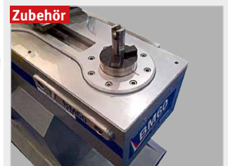
Aufnahmen für Werkzeuge anderer Hersteller möglich
