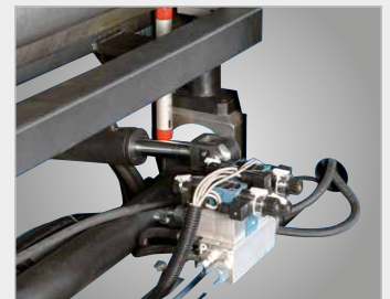
Die Parallelität der unteren Walze wird durch eine Torsionswelle gewährleistet
