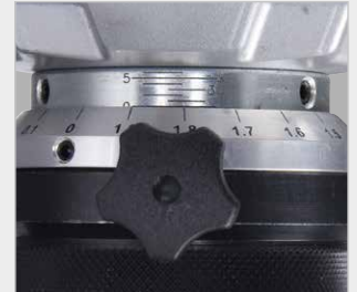
▶ Fasenbreite von 0 - 6 mm stufenlos einstellbar ▶ Bequeme und exakte Einstellung der Fasenbreite dank leicht lesbarer Skala
