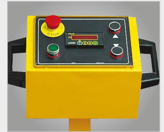
► Digitale Positionsanzeige für Zustellwalze
