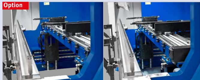
▶ Optionen Hinteranschlag mit Z1- und Z2-Achse sowie Delta-X
