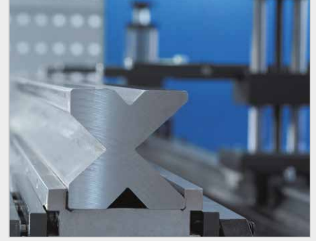
▶ serienmäßige Zentrierschiene mit optionaler, gehärteter und geschliffener Multi-V-Matrize
