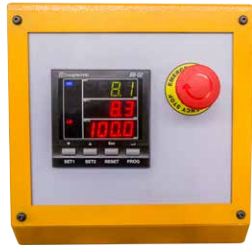
▶ Bedienpult mit Digitalanzeige und NOT-AUS-Schalter
