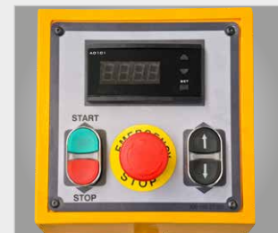
▶ Digitale Positionsanzeige für Zustellwalze
