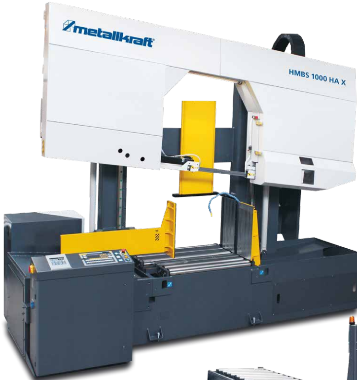
HMBS 1000 HA X mit optionaler Bündelspannvorrichtung (Art.-Nr. 3640130)
