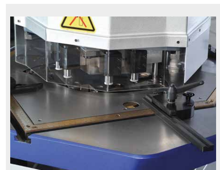
Arbeits-tisch mit T-Nuten und versenkten Skalen · Hydraulik-Niederhalter
