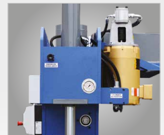
▶ Seitliche Räumpresse mit Druckmanometer
